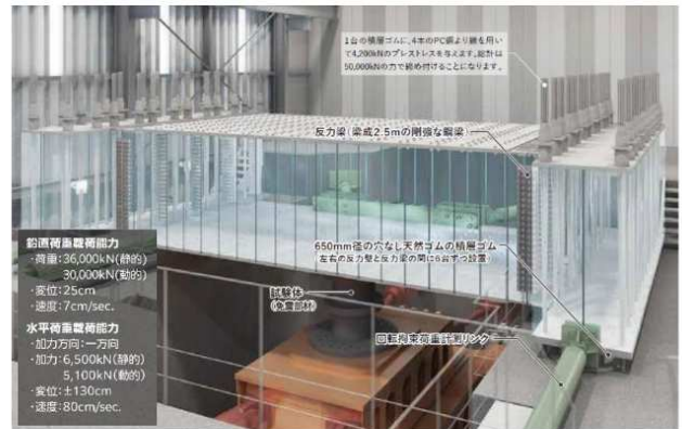
実大免震試験機の概要 (E-Isolation パンフレットより)
